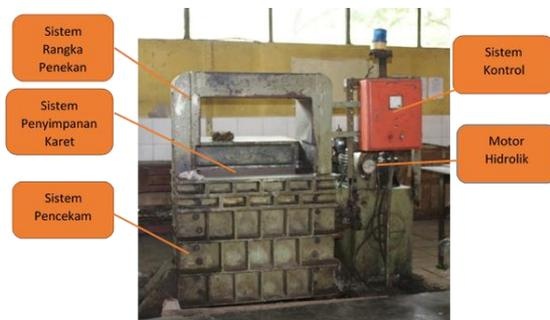
Pada gambar di atas menunjukkan mesin *baling press* yang ada di perusahaan. Mesin mempunyai sistem rangka penekan, sistem penyimpanan karet, sistem pencekam, sistem kontrol, dan motor hidrolik. Karena mesin tersebut
